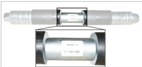
→ Vergleichen, ob Flanschbreite F des I-Trägers innerhalb des Bereichs ist, der auf dem Fahrwerksbolzen angegeben ist.
